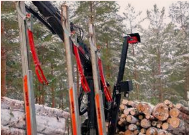
YTTRE ÖGAT. Den röda kameran är den som ger bilden till VR-glasögonen som föraren använder inne i hytten för att styra kranen. På sidorna om timret sitter de så kallade bankarna som håller fast timret, och även dessa styrs från hytten.
